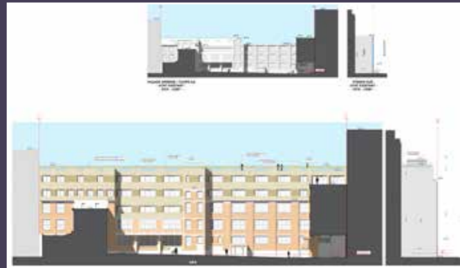
Élévation de la façade sur la cour, état projeté (en vignette, état existant) (© RDI Architecture).
