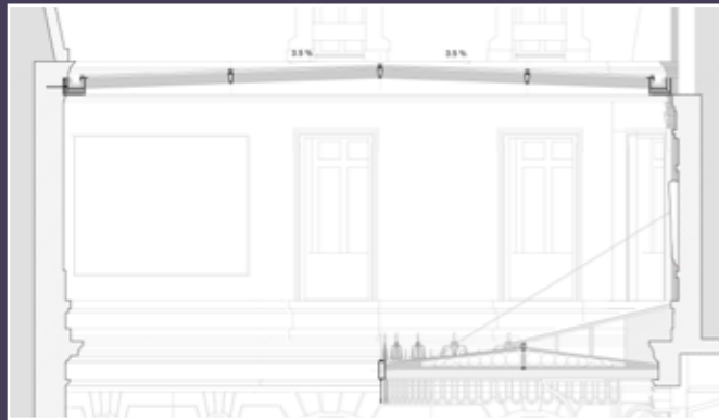
Coupe transversale sur la marquise (détail), état projeté présentant l'ajout de la verrière (© CALQ).
