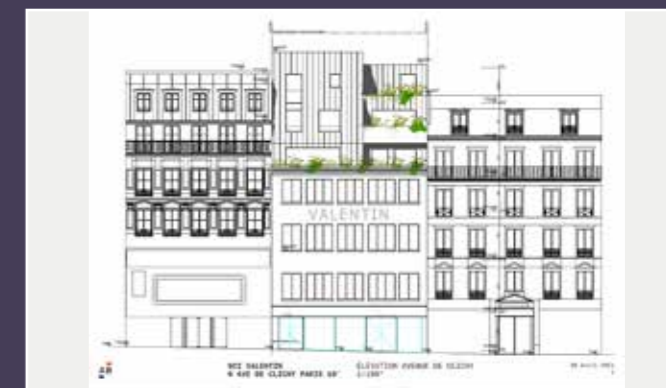
Élévation de la façade principale, état projeté dans le cadre d'une surélévation (© A. Beckmann).
