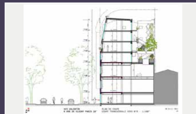
Coupe, état projeté dans le cadre d'une surélévation (© A. Beckmann).
