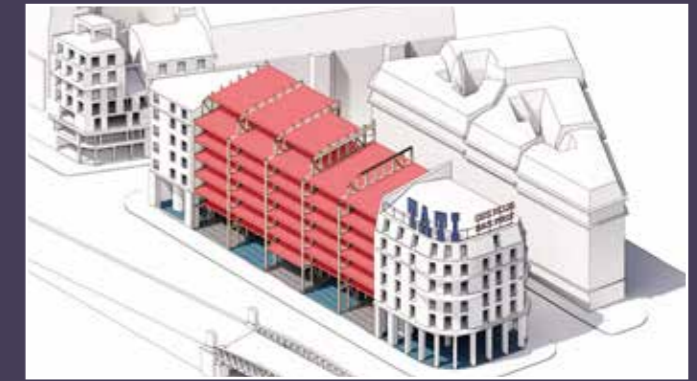
Axonométrie avec indication schématique des nouvelles constructions à réaliser suivant le parcellaire, suite à démolition de l'existant (promoteur Altarea, ©Mars Architectes)
