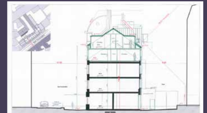
Coupe projetée avec le profil de toiture existant (© Agence Terrones architectes).
