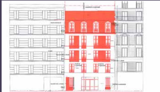
Élévation de la façade, état existant présentant en rouge les démolitions envisagées (© Franck Salama architecte).
