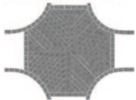
Raccordement dans un carrefour sous la forme d'une croix de chevalier
