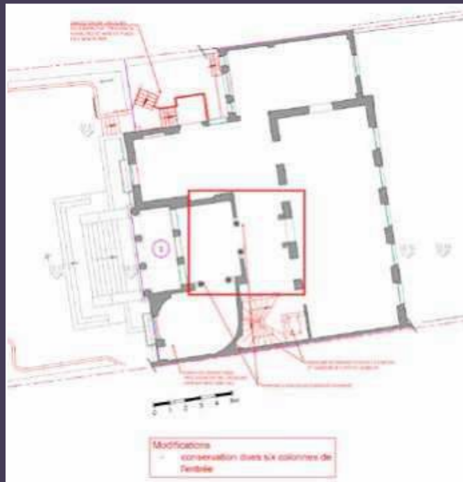
Plan des démolitions envisagées au rez-de-chaussée, sans les serliennes, seconde version (© Artquad Architectes).
