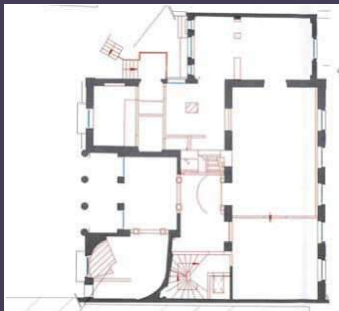
Plan des démolitions envisagées au rez-de-chaussée, dont les serliennes, première version (© Artquad Architectes).
