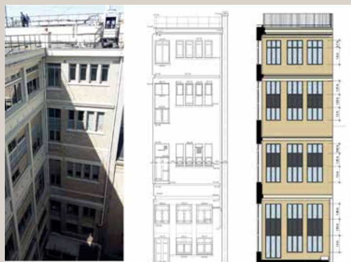
Élévation d'une façade sur la cour du bâtiment Madrid, photo, état existant et projeté (© Studios architecture).
