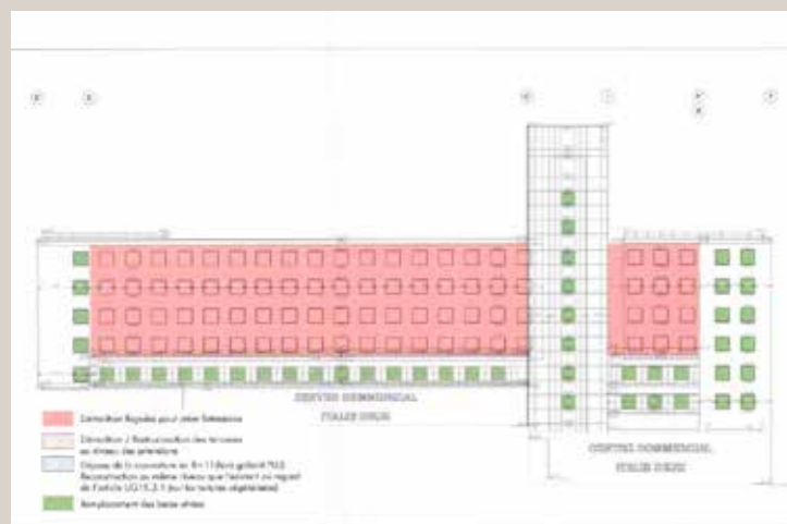
Élévation de la façade sud, état existant présentant les démolitions (en rouge) et les éléments remplacés (en vert) (© CALQ).
