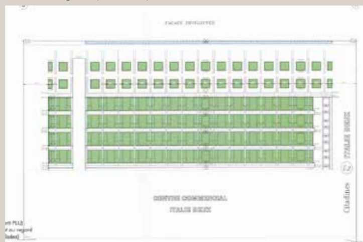
Élévation de la façade de l'immeuble-pont, état existant présentant le remplacement des baies (en vert) (© CALQ).
