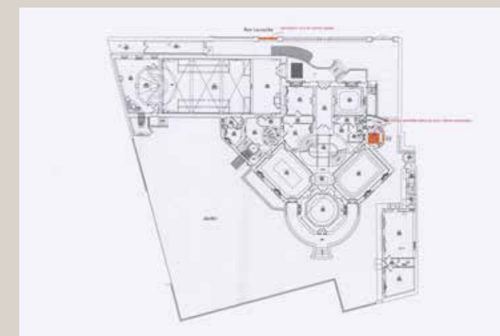
Plan du rez-de-chaussée, état existant présentant en rouge les démolitions envisagées (© Bruno Le Moal).
