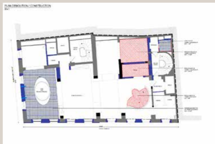
Plan présentant les démolitions envisagées au R+1 (étage d'entresol) (© Barbaritobancel Architectes).
