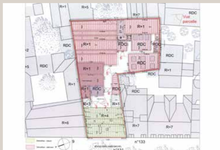
Plan-masse, état existant présentant les démolitions totales (en rouge) et les démolitions de toiture (en vert) (© Najaa architectes).
