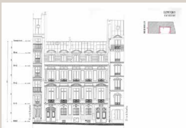
Élévation de la façade sur rue, état existant (© Sahuc & Katchoura architectes).
