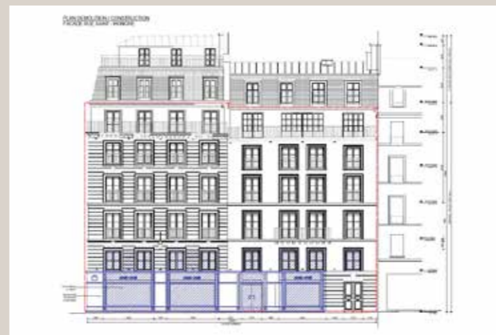
Élévation de la façade sur la rue Cambon présentant les démolitions envisagées (© Barbaritobancel Architectes).
