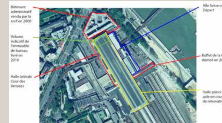
Localisation indicative des parties de la gare et de l'avancement des travaux. (Fonds photographie IGN 1993) (© D.H.A.A.P.).
