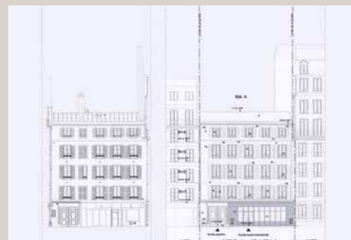
Élévation de la façade sur le boulevard, état existant (à gauche) et nouveau projet (à droite) (© Naaja architectes).
