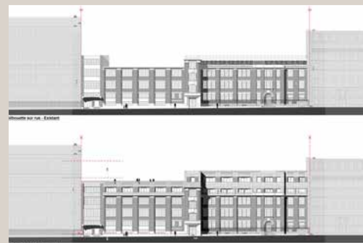
Elevation actuelle en haut et projetée en bas (©RDI Architecture).
